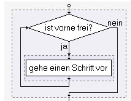
Genau so steht es auch im Quelltext. Im runden Klammerpaar hinter dem Schlüsselwort `while(...)` steht die Bedingung, welche die Wiederholungen steuert. Solange diese Ausführungsbedingung gilt, werden alle Anweisungen im Schleifenblock zwischen `{` und `}` wiederholt.
