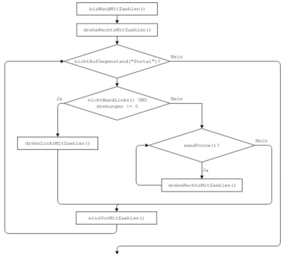
Der Roboter wird nicht immer so gut informiert, wie sein Einsatzgebiet aussieht. Unsere hohen Entwicklungskosten sollen nicht verloren gehen, nur weil der Roboter irgendwann mal den Ausgang nicht wiederfindet. Daher bekommt der Roboter ein Not-Programm mit dem er in beliebigen Umgebungen den Ausgang (gekennzeichnet durch das Portal) immer wiederfindet, egal wie viele Ecken und Wände im Weg sind.
