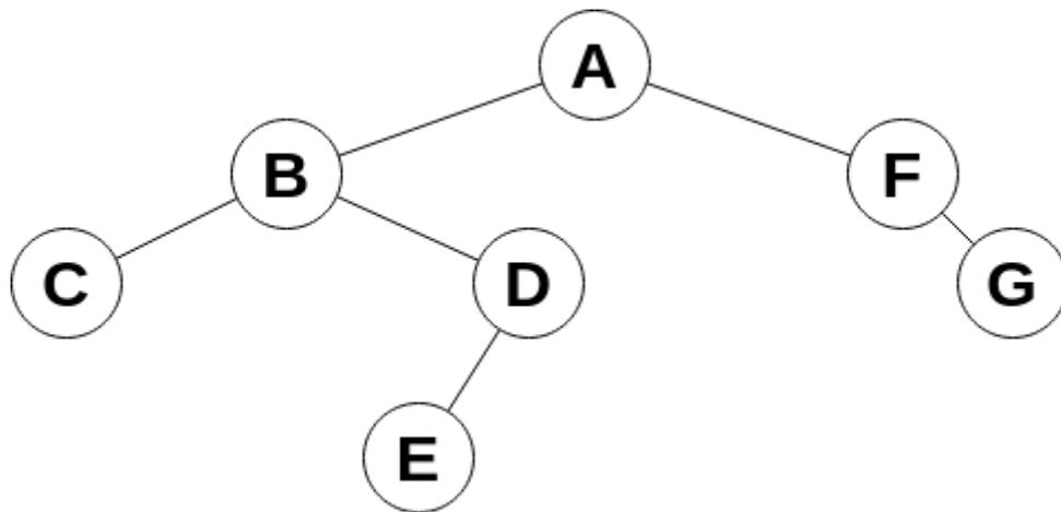
Bei der Levelorder Traversierung werden auf jedem Niveau des Baums erst alle Knoten besucht, bevor auf das nächste Niveau gewechselt wird, in unserem Beispielbaum ergibt sich damit die Traversierungsreihenfolge: A→B→F→C→D→G→E. Der Algorithmus zur Levelorder Traversierung ist nicht rekursiv.
