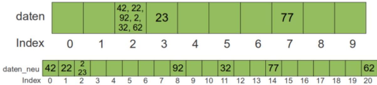
Man legt ein neues Array der Länge z.B. 21 an und sortiert die bestehenden Werte neu ein. Viele der Kollisionen treten jetzt nicht mehr auf, es können aber neue Kollisionen entstehen, die Behälter enthalten jetzt im Durchschnitt weniger als einen Wert.
