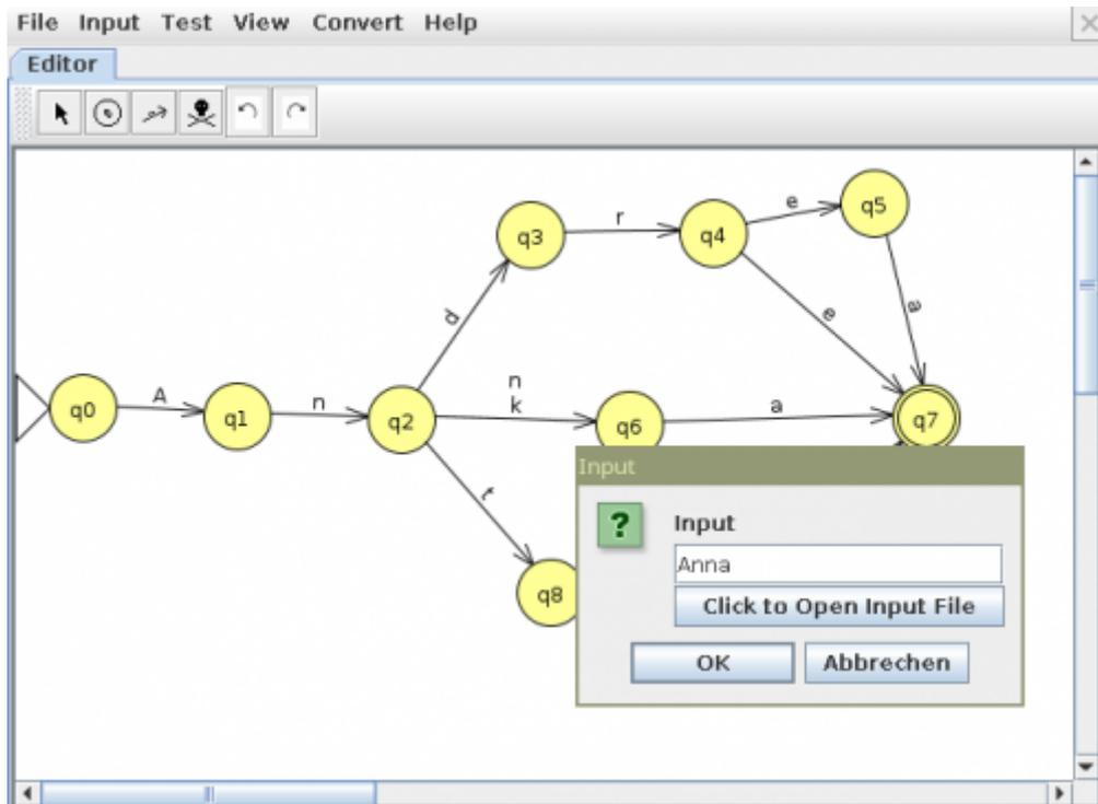
Dann öffnet sich ein Fenster, in dem du das Verhalten des Automaten schrittweise nachvollziehen kannst, indem du auf den Button Step klickst. Um den Automaten erneut mit der gleichen Eingabe zu starten, musst du Reset drücken. Möglichkeit 2: Mehrere Eingaben verarbeiten
