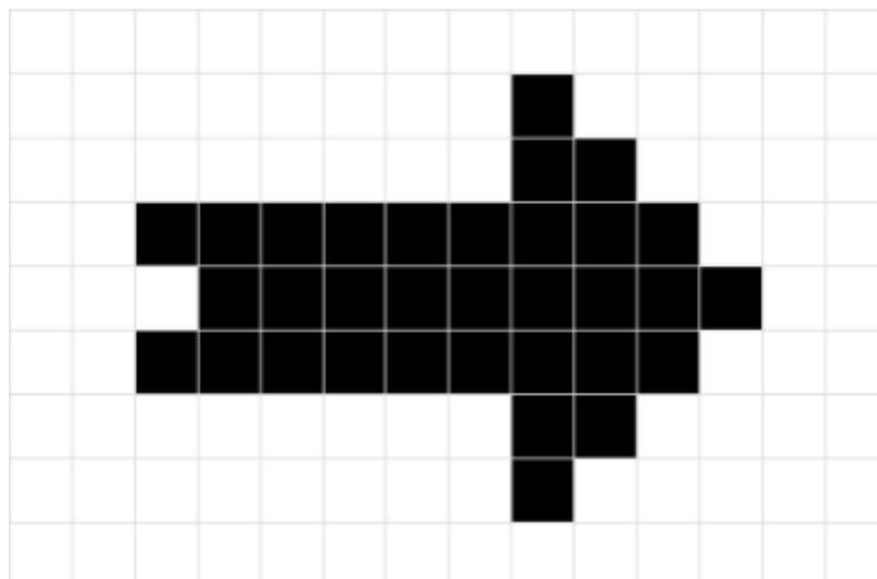
Untersucht man das Bild jetzt zeilenweise und betrachtet die folgenden 4 möglichen "Pixelpaare", kann man das Bild mit der Huffman-Codierung komprimieren:
