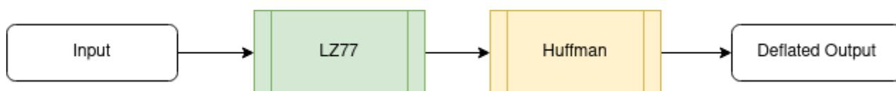
Die Eingabedaten werden zunächst mit einem Vorläufer des LZW-Verfahrens bearbeitet ([LZ77](#)). LZ77 funktioniert in Teilen ähnlich wie LZW, führt jedoch kein Wörterbuch sondern verweist auf frühere Vorkommen identischer Bitmuster. Das Ergebnis dieser Kompression wird dann mit einer Huffman-Codierung weiter verkleinert, einige Implementationen schließen zuletzt noch eine Lauflängencodierung an.
