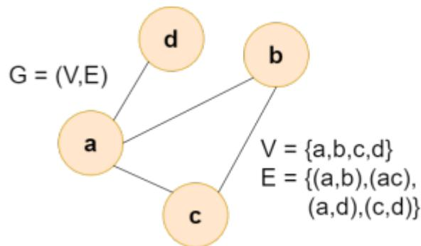
Ein Graph ist ein Gebilde, das aus Knoten und Kanten besteht. Jede Kante verbindet zwei Knoten oder einen Knoten mit sich selbst. Von einem Knoten können eine, mehrere oder keine Kanten ausgehen. Formal schreibt man:
