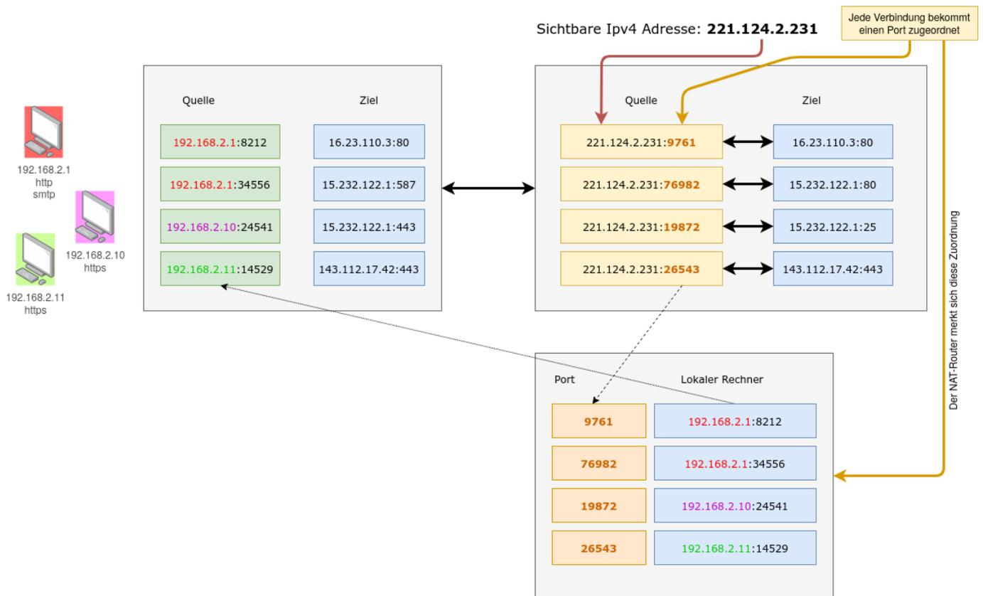
Außerdem wird die intern verwendete Portnummer des Clients durch einen freien Port des Routers ersetzt. Dieser tritt gegenüber Servern im Internet somit als Absender aller Datenpakete auf, die aus dem lokalen Netzwerk versendet werden.
