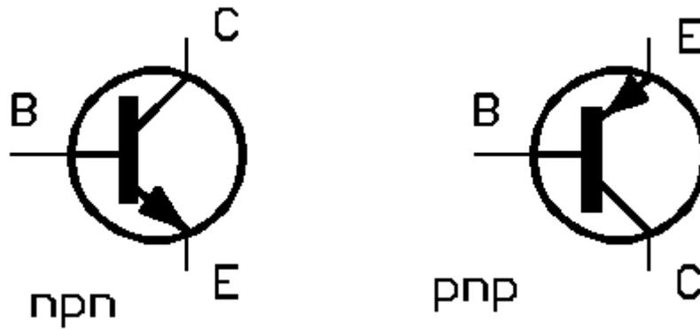
Ein Transistor hat drei Anschlüsse, diese werden mit **B**asis, **C**ollector und **E**mitter bezeichnet.
