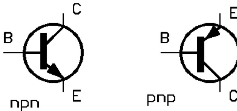
Ein Transistor hat drei Anschlüsse, diese werden mit **B**asis, **C**ollector und **E**mitter bezeichnet. Je nachdem, wie die Halbleiterschichten im Inneren des Transistors dotiert sind, kommen gewöhnliche Halbleitertransistoren in zwei Varianten als pnp und npn-Transistoren. Wir betrachten im weiteren **npn-Transistoren**.
