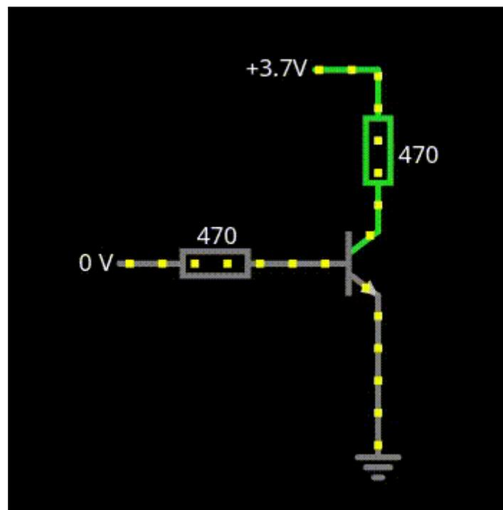
Wenn man die Basisspannung erhöht, fließt ein großer Strom von C nach E, ein kleiner von B nach E. Durch das Anlegen einer Spannung an der Basis des Transistors wird die C-E Strecke durchlässig geschaltet - der Schalter ist geöffnet. Wenn man die Basisspannung wegnimmt ist C-E für Ladungsträger undurchlässig - der Schalter ist geschlossen.
