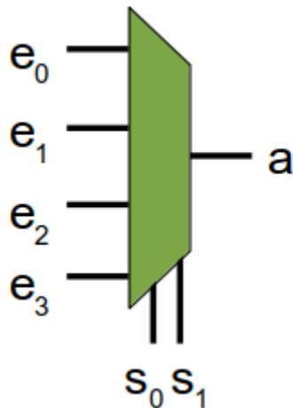
Mit den Steuerleitungen  $s_1$  und  $s_0$  wird binär codiert, welche Eingangsleitung  $e_0$  bis  $e_3$  an den Ausgang durchgeschaltet wird.  $s_0$  ist dabei das niedrigere Bit,  $s_1$  das höhere. Zum Beispiel wird, wenn  $s_0 = 0$  und  $s_1 = 1$  ist<sup>2)</sup>  $e_2$  zu  $a$  durchgeschaltet.  $s_0 = 0, s_1 = 1 \rightarrow$  binär 2,  $e_2$  wird durchgeschaltet.
