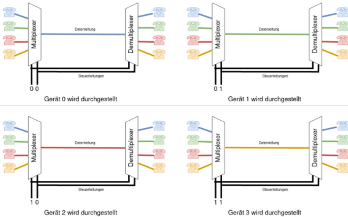
Die Signale auf den Steuerleitungen sorgen dann dafür, dass Multiplexer und Demultiplexer synchron arbeiten.
