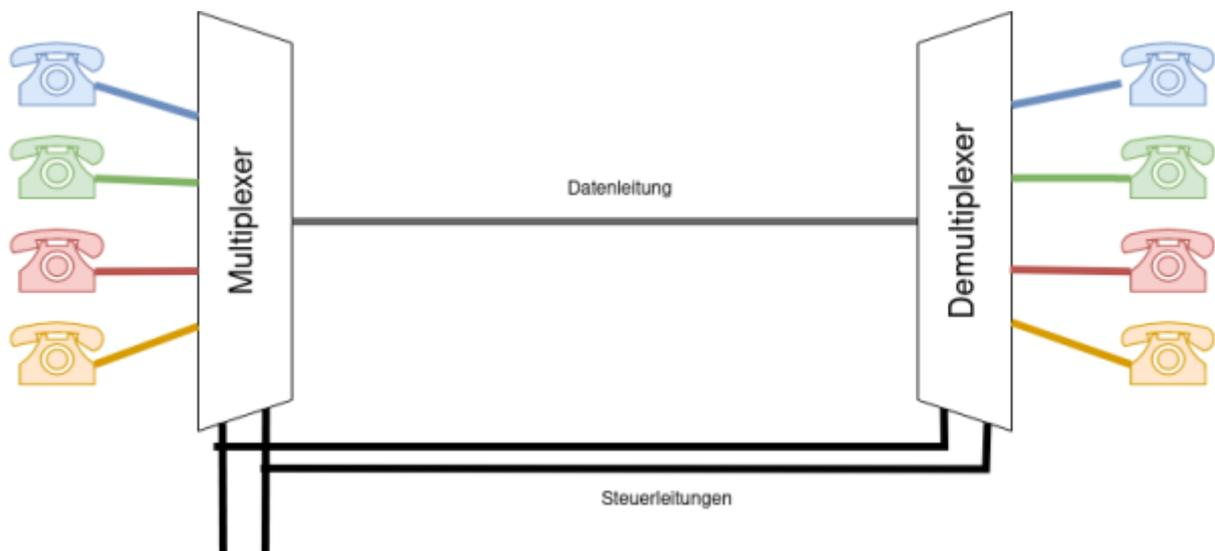
Eine gemeinsame Leitung soll von 4 Nebenstellen (Gerät 0 bis 3) verwendet werden. Der Multiplexer muss also aus mehreren Eingangssignalen dasjenige auswählen, das auf die Verbindungsleitung geschickt werden soll. Der Demultiplexer am anderen Ende hingegen muss dieses eine Eingangssignal an einen von mehreren Ausgängen weiterleiten.
