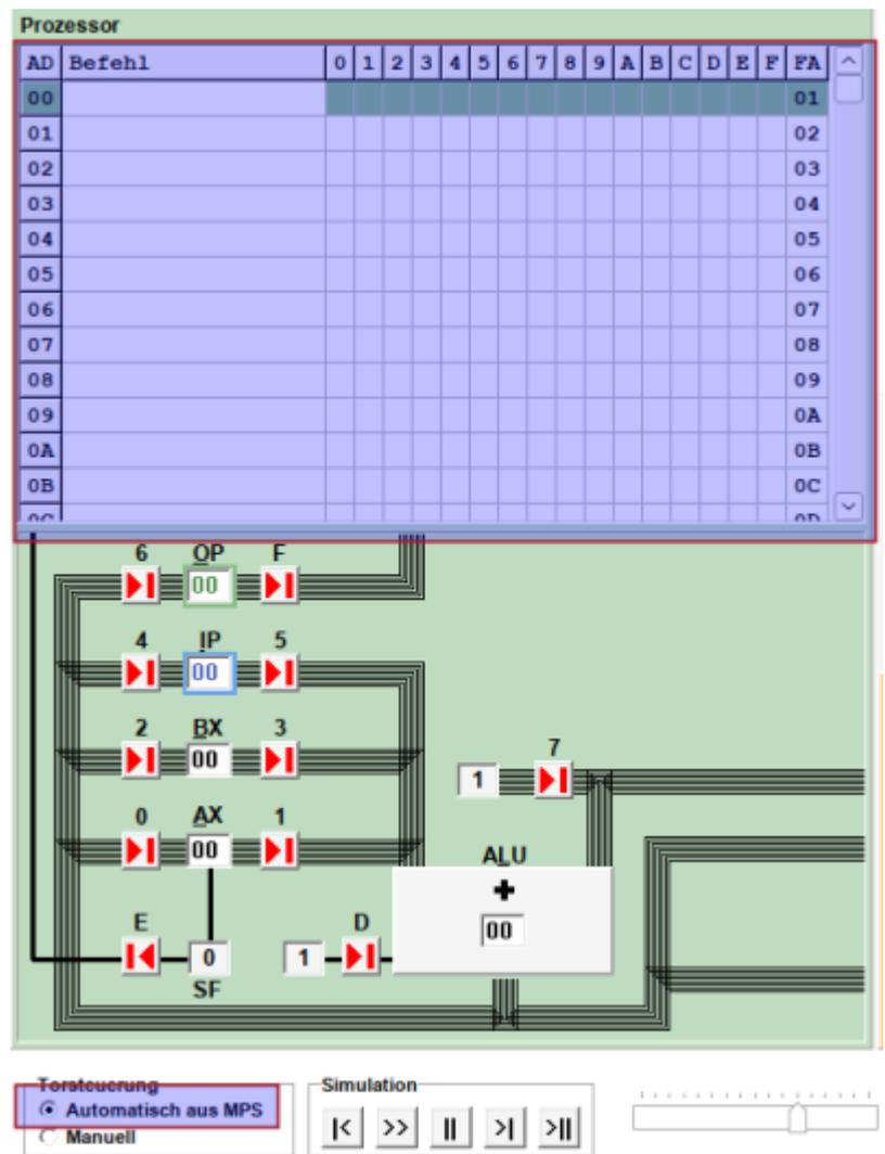
Im oberen linken Fensterbereich können sogenannte "Mikroprogramme" gespeichert werden. Ein Mikroprogramm besteht aus einer Reihe von Angaben, welche Tore geöffnet werden sollen, jede Zeile entspricht dabei einem ALU Takt. Um Mikroprogramme auszuführen muss man links unten die Option "Automatisch aus MPS" wählen.
