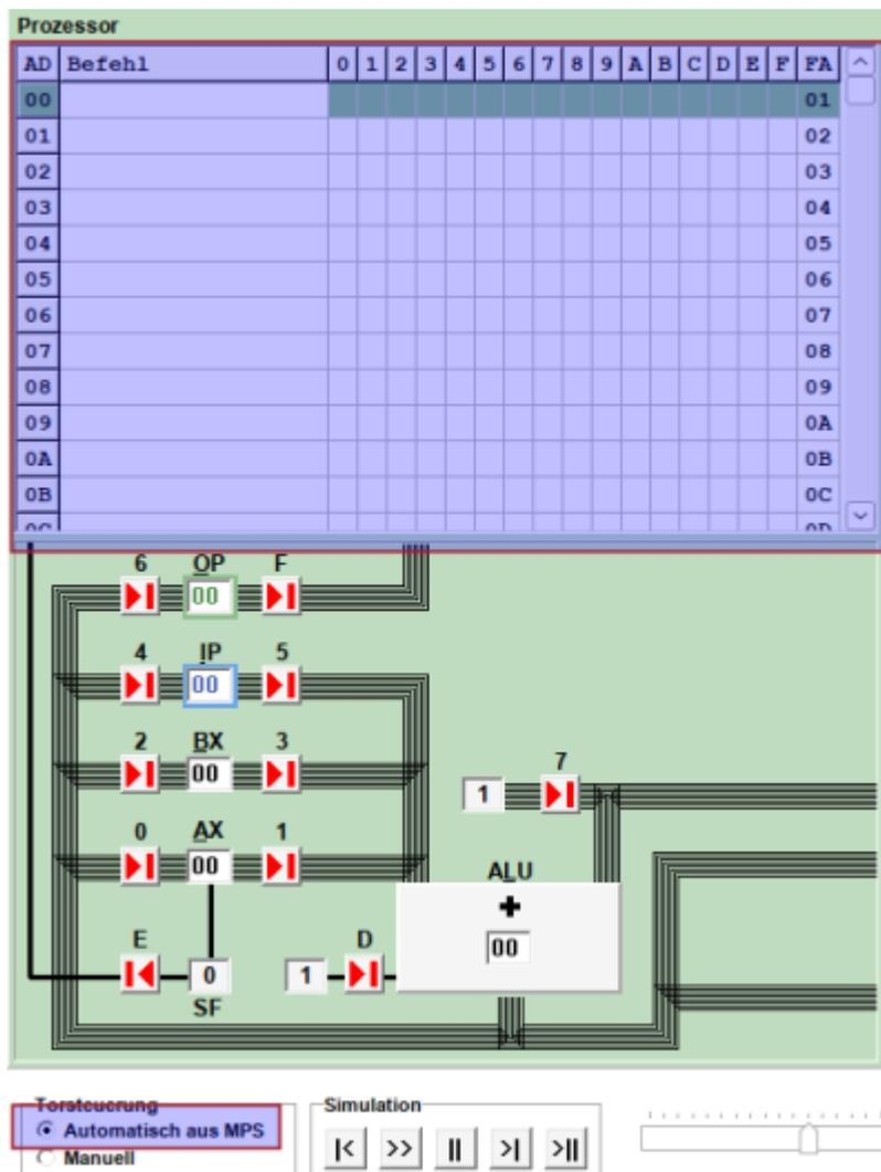
Im oberen linken Fensterbereich können sogenannte "Mikroprogramme" gespeichert werden. Ein Mikroprogramm besteht aus einer Reihe von Angaben, welche Tore geöffnet werden sollen, jede Zeile entspricht dabei einem ALU Takt. Um Mikroprogramme auszuführen muss man links unten die Option "Automatisch aus MPS" wählen.
